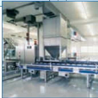
L'image montre un poste de remplissage pour containers avec transporteur à rouleaux.
