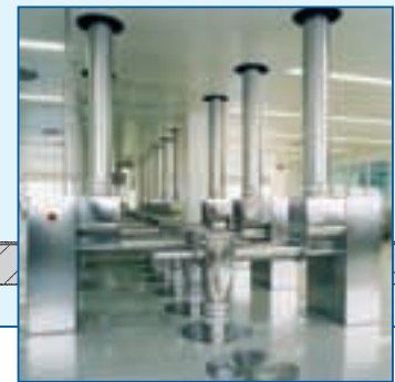
L'image montre des dispositifs de dosage, alimentés par containers. Le dosage s'effectue dans une peseuse pour containers se trouvant à l'étage inférieur.
