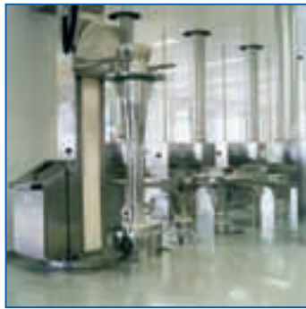
L'image montre un poste de déchargement pour fûts avec transvasage dans la peseuse pour containers se trouvant au-dessous.
